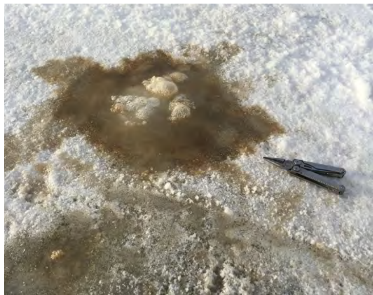
Það veit ekki á gott þegar metan og hydrogen sulphide brýtur sér leið gegnum ísinn. Ljósmynd: Ole Albert Kjøsnes, Byneset-völlurinn 2016.
