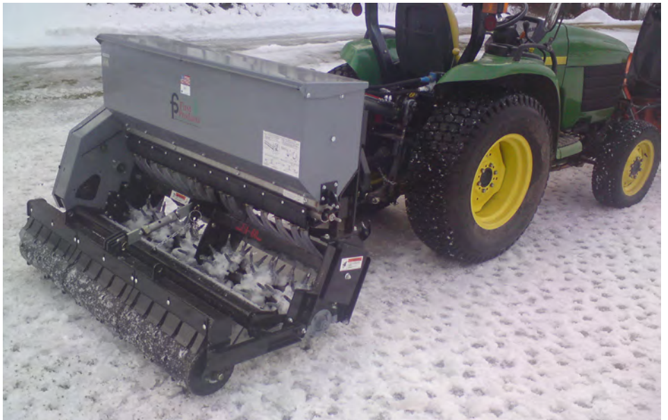
Þessi vél er ekki aðeins vinsæl til sáningar. Titrandi pinnarnir geta líka brotið ís. Ljósmynd: Tor Mjæen.
