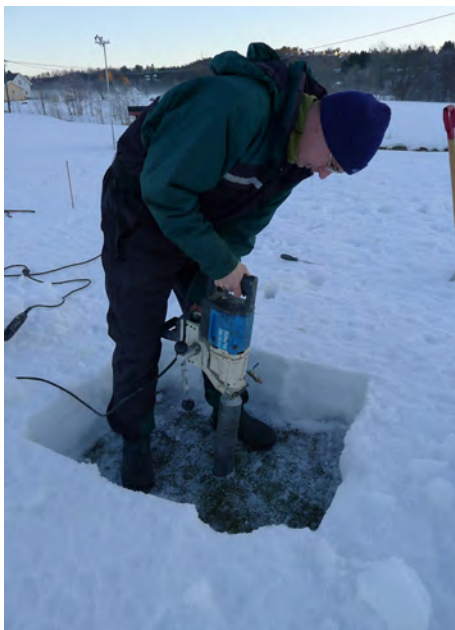
Það er ekki tekið út með sældinni að vakta frosið gras. Hér er steypubor notaður til að taka sýnishorn. Ljósmynd: Agnar Kvalbein, NIBIO Landvik.
