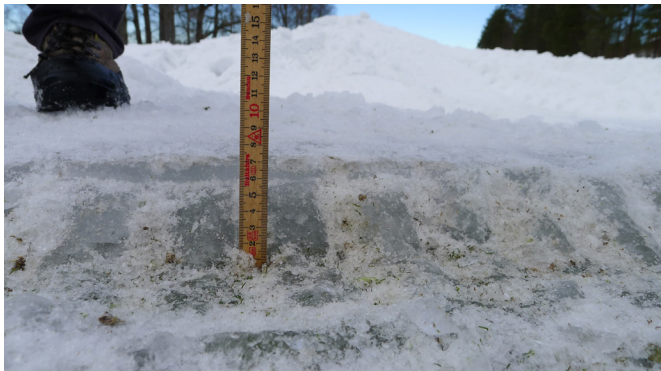
Hér hafði 7 cm þykkt svell myndast undir snjó. Svell með mörgum gropum (loftgötum) er hvítt á lit, en þétt svell er glært. Ljósmynd: A. Kvalbein.
