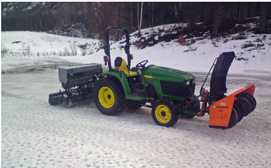
Framdrifinn snjóblásari er hér notaður ásamt víbrunargatara sem hentar vel til að brjóta ís. Ljósmynd: A.Kvalbein.
