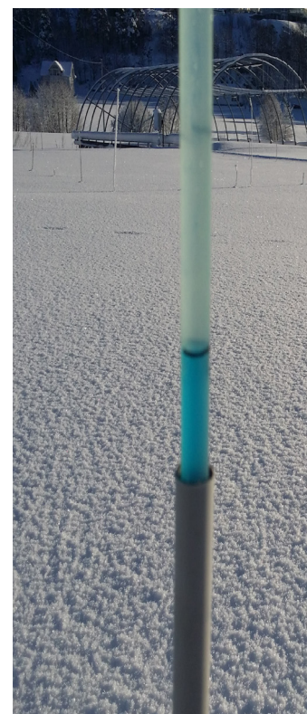
Hægt er að búa til frost- og snjódýptarmæli eins og þennan. Ljósmynd: T.O. Pettersen.
