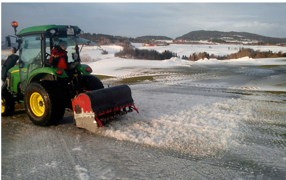
Gamall gátari er hér notaður til að brjóta svell á golfvelli í Þrándheimi, þar sem svella verður vart á næstum hverjum vetri. Ljósmynd: Ole Albert Kjøsnes.
