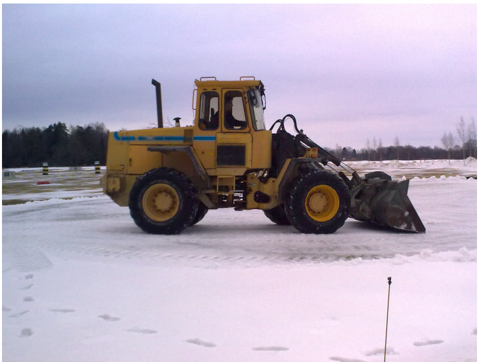
Hjólaskófla er ekki mest notaða tækið á flötum, en kemur til greina ef frostdýpi er mikið. Ljósmynd: Magnus Barth.
